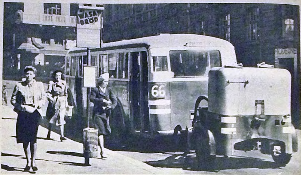
Omnibus con aggregati doppi. A causa delle numerose e ripide salite che debbono superare, questi omnibus rossi hanno nel loro rimorchio persino due aggregati
