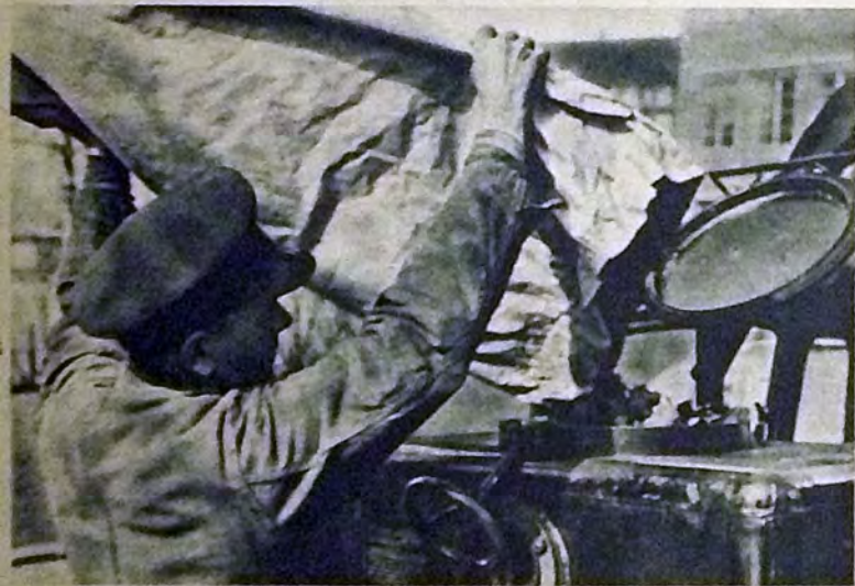
Prima della partenza bisogna accendere il carbone — l'autista si fa fuoco. La maggior parte degli aggregati hanno una capacità da 200 a 250 litri di carbone di legno, sufficiente a coprire un percorso di circa 150 chilometri
